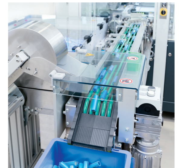
Zuführung von Zellen mit Bunkersystem.
